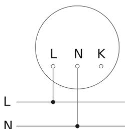
Schema elettrico Master-Master collegamento in rete
